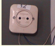
Kamufaż nadajnika podchuchowego (miotazo elektryczne)
