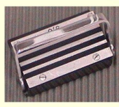
Urządzenie do przecinania filmu do wymiaru 9,5 mm (do aparatu AJAX)
