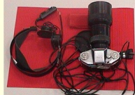
Urządzenie podchuchowe do dalszych odległości (zakamuflowane w postaci aparatu fotograficznego z lat 50-80 tych ze słuchawkami (EXA II, IMAGE Dorside)
