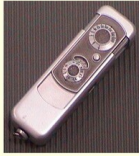
Aparat fotograficzny MINOX-WETZLAR na mikrofilm (8 mm), produkcji zachodniemieckiej, konstrukcja z lat 40-50 tych
