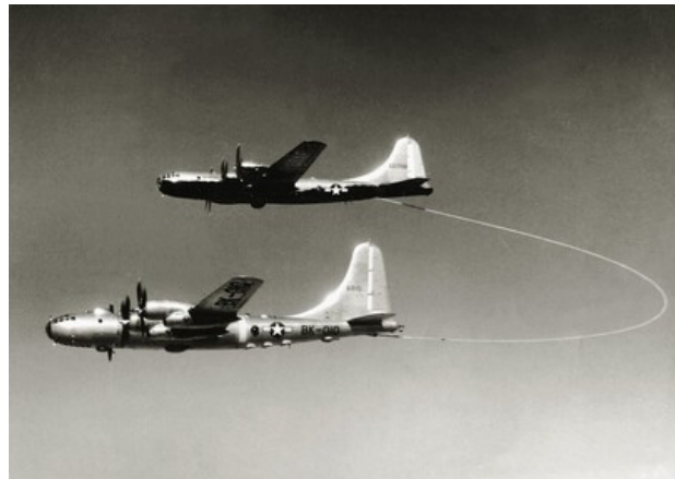
Boeing B-50 Superfortress „Lucky Lady II” podczas tankowania w locie. Źródło: Wikimedia Commons
