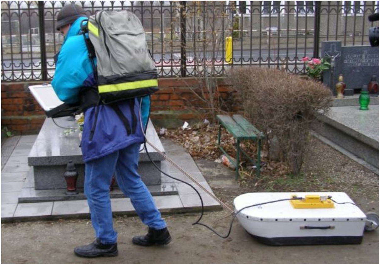
Dr Adam Szykiewicz z Uniwersytetu Wrocławskiego bada georadarem teren na cmentarzu w Dzierżoniowie
