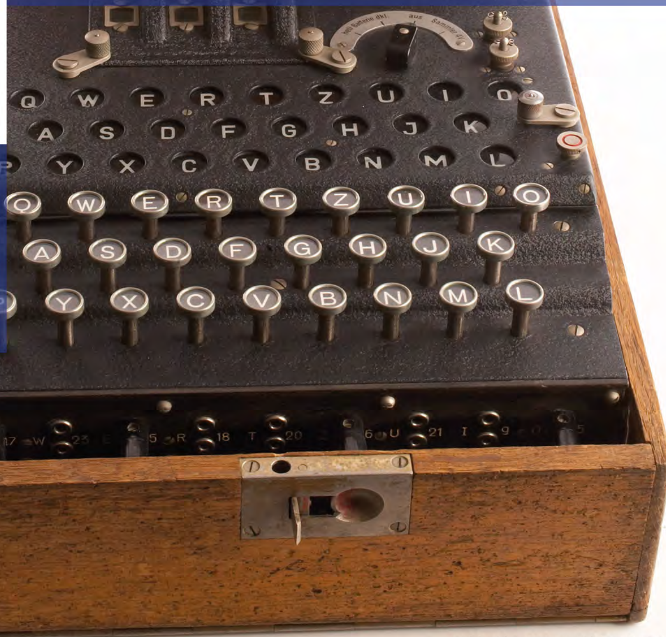
Model wojskowej Enigmy z widocznymi trzema wirnikami oraz łącznicą Fot. Domena publiczna
