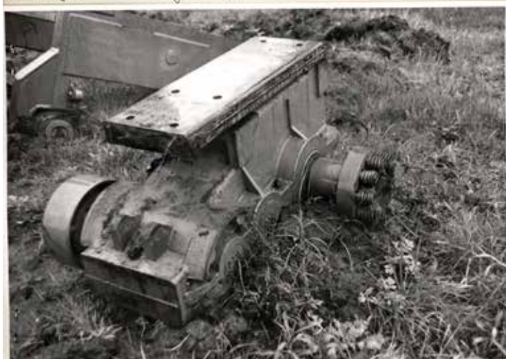
Elementy urządzenia szynowego ugniecione w ziemię.
