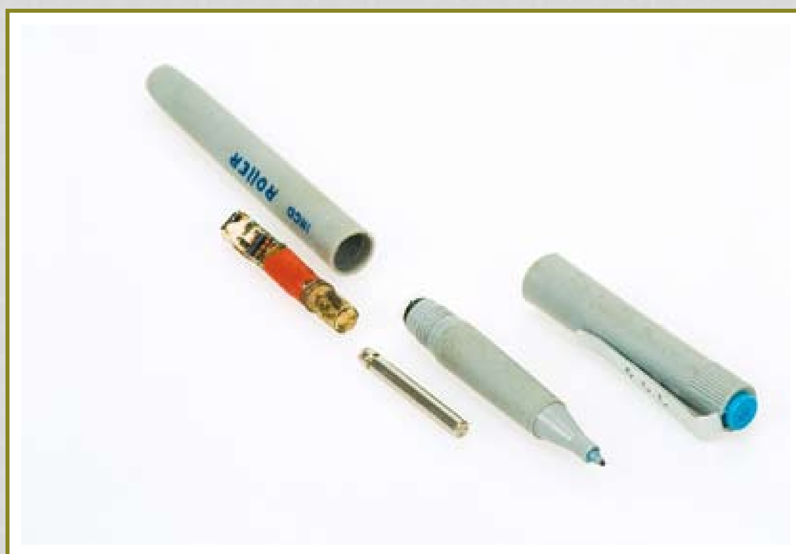
Podśluch zamontowany w długopisie
