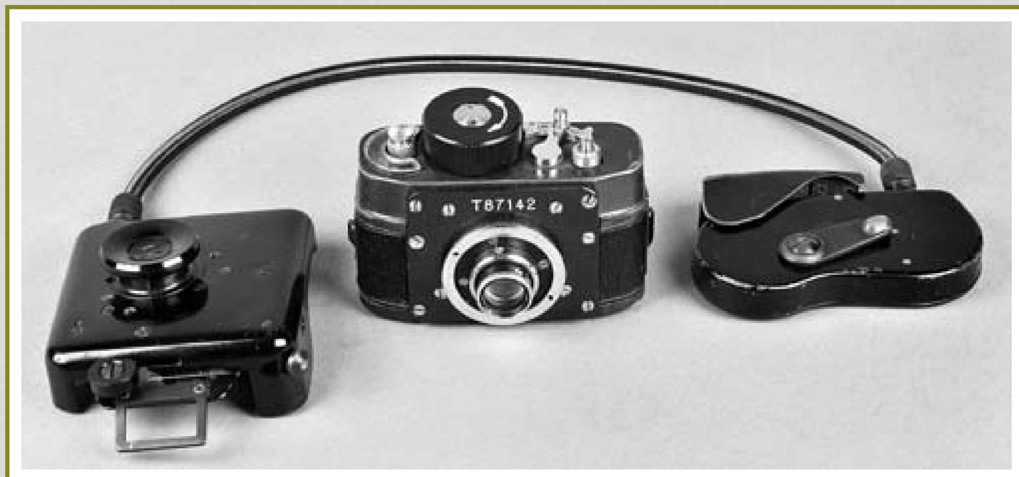
Aparat „Ajax” ze sprzętem do kamuflażu – wyzwalacz migawki – konstrukcja do zamaskowania obiektywu
