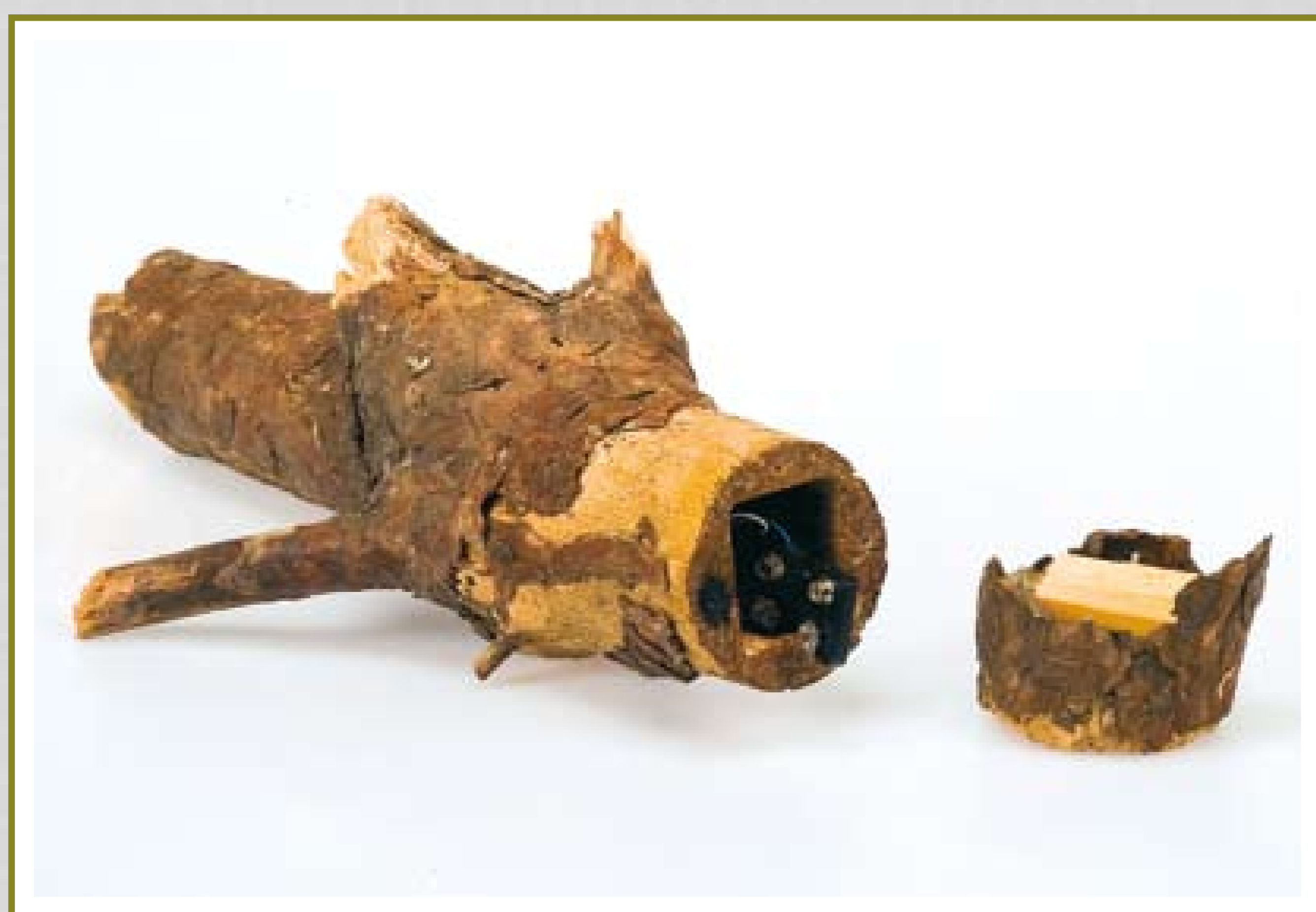
Podśluch zamontowany w kłodzie drzewa
