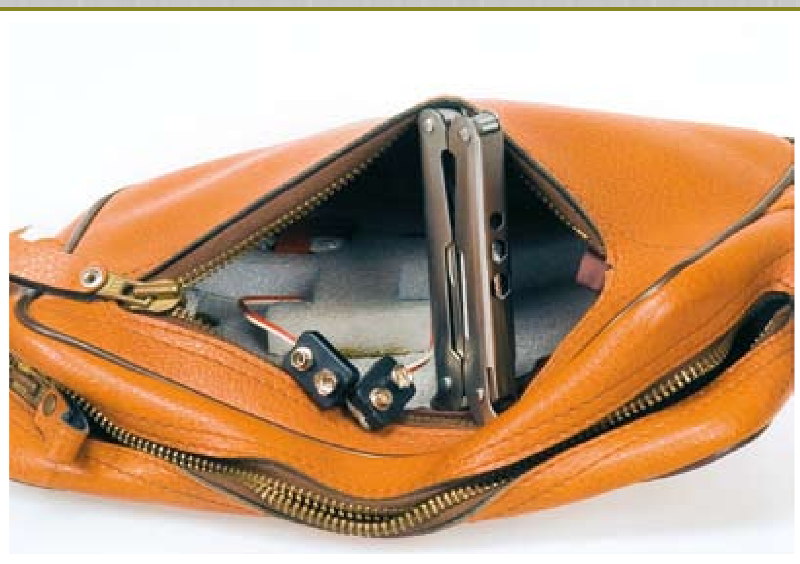
Podśluch zamontowany w torbie
