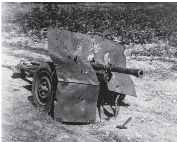
Fot. 24. Zniszczona armata przeciwpancerna kpr. Stefana Kały z 24. pułku ułanów. Widoczne są liczne trafienia w tarczę ochronną, uszkodzenia lufy i oporopowrotnika (ze zbiorów Łukasza Stożka).
